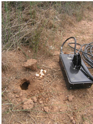
Détection d'un nid de tortues de Floride par un géo-radar
